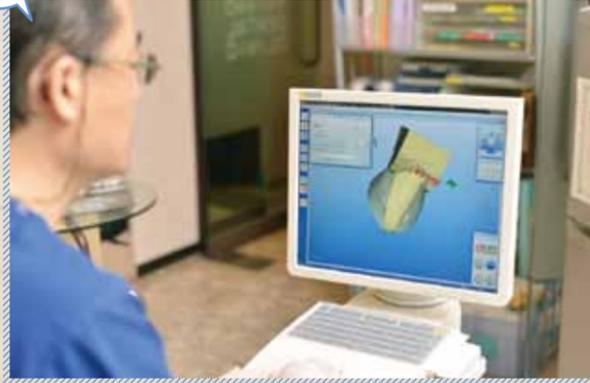
歯の形を専用カメラで撮影し、コンピューターに3次元データとして取り込む。それをもとに最新機器「セレック3」を使ってセラミックのブロックから詰め物を削り出す。虫歯の大きさや噛み合わせの関係などもそのまま反映、非常に精密な詰め物ができる。これは医療先進国ドイツで開発された、コンピューター制御による歯の修復物設計・製作をするCAD/CAMシステムで、日本で導入している歯科医院はまだ少ないという。
